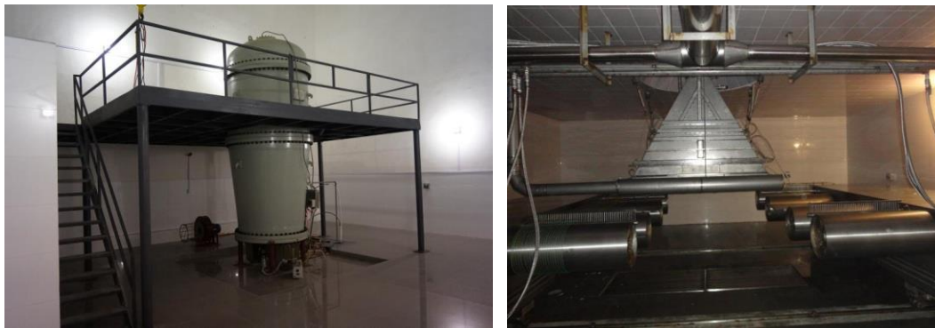
(a) ELV-8 型加速器主机外观 (b) ELV-8 型加速器辐照窗外观
