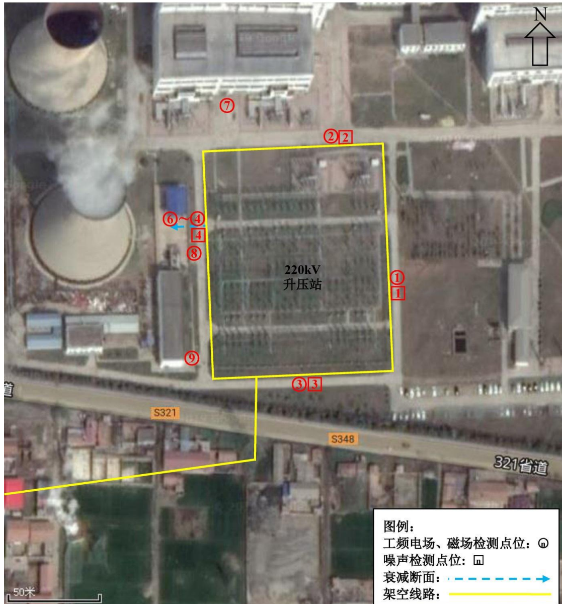
图 3-7 大屯能源 220kV 变电站监测点位图
