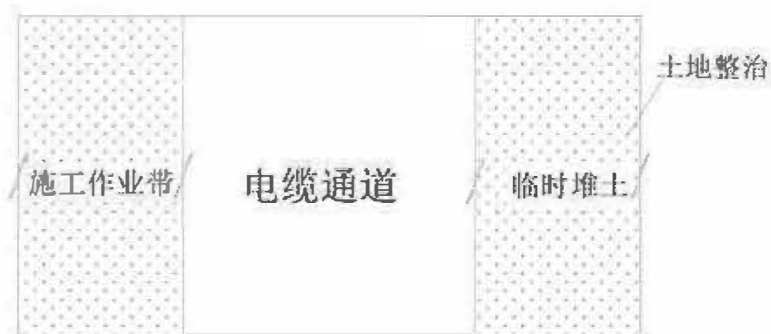
电缆通道施工环保措施
