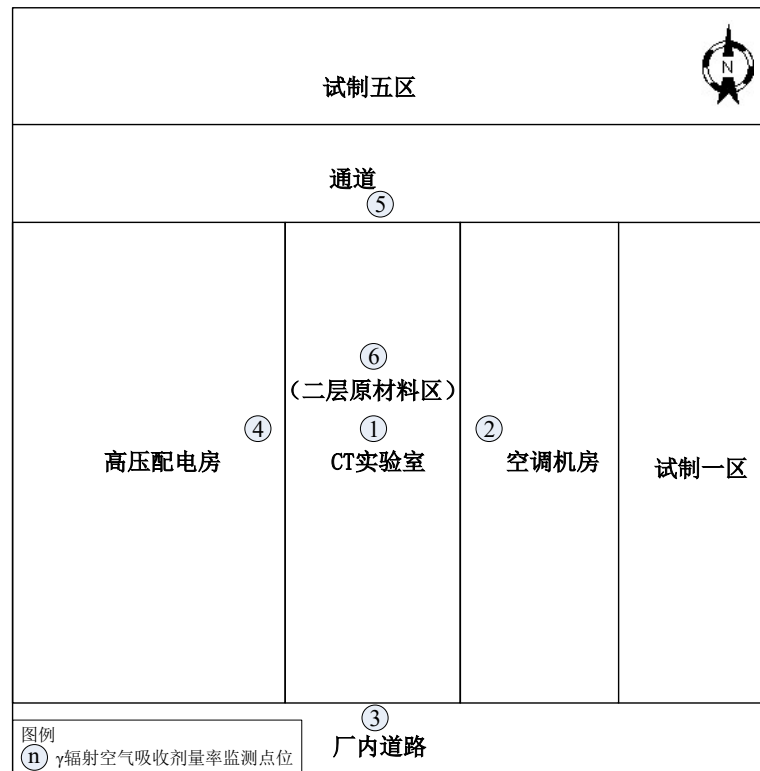
图 8-2 本项目 CT 实验室建址周围环境 \gamma 辐射空气吸收剂量率监测点位示意图
