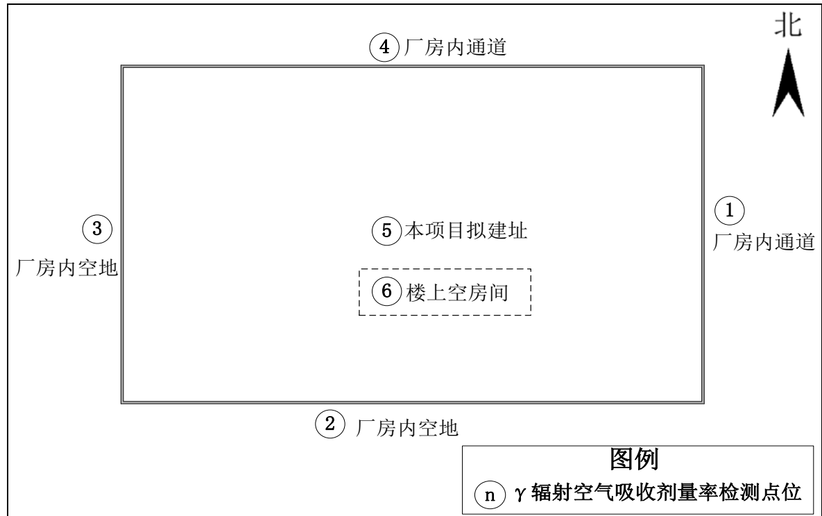
图 8-6 本项目周围环境 \gamma 辐射空气吸收剂量率监测点位示意图
